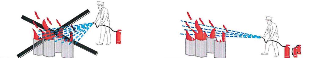
Olio e benzina accesi, situati in contenitori aperti, non vanno mai spenti usando l'estintore dall'alto, ma orientando il getto dell'estintore sul bordo del contenitore, cercando di rompere la fiamma per permettere il soffocamento dell'incendio.
