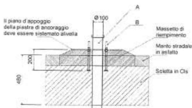
Installazione con piastra di ancoraggio con tubazione per passaggio cavi che attraversa il manto stradale
